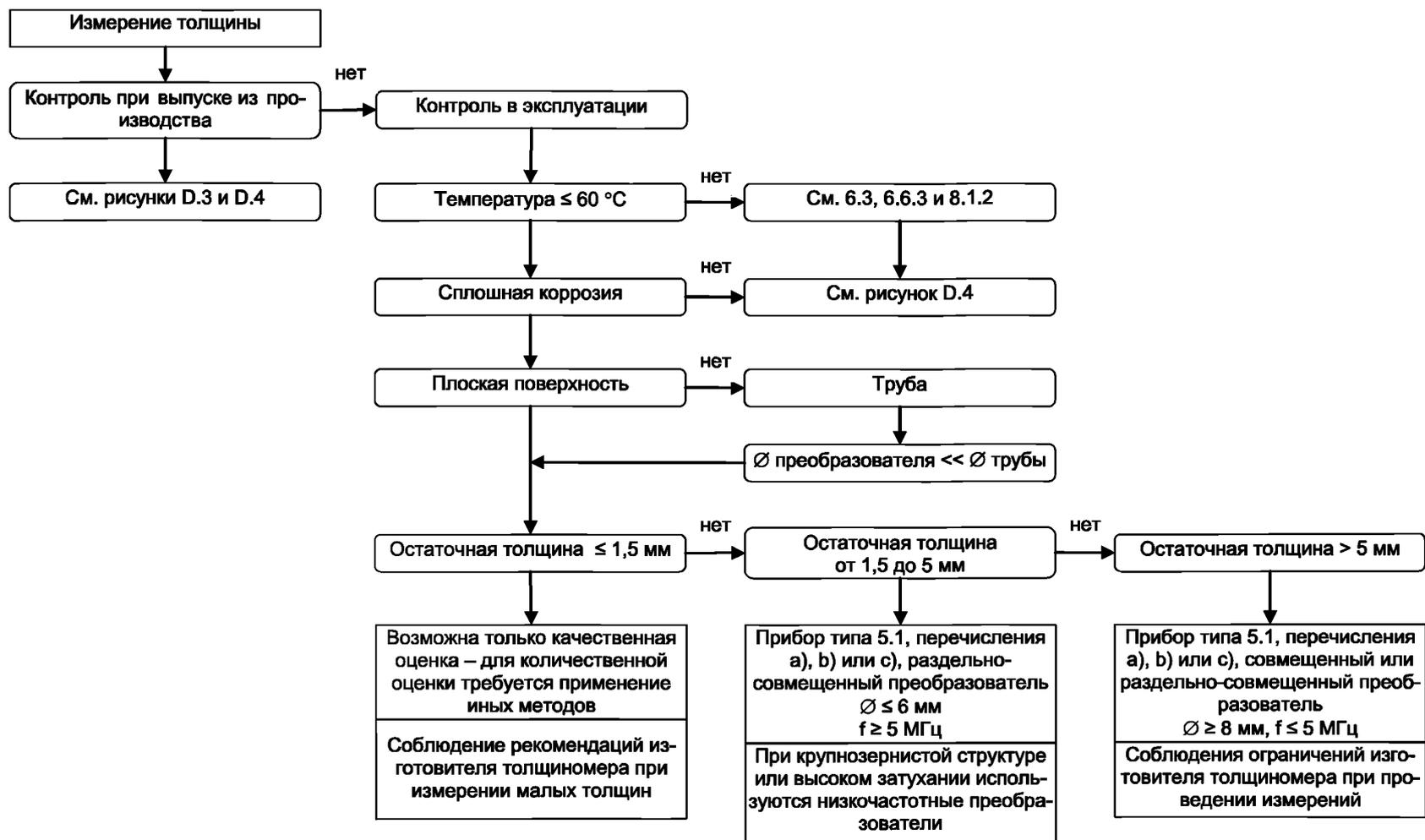
Рисунок D.3 — Блок-схема проведения контроля в эксплуатации
