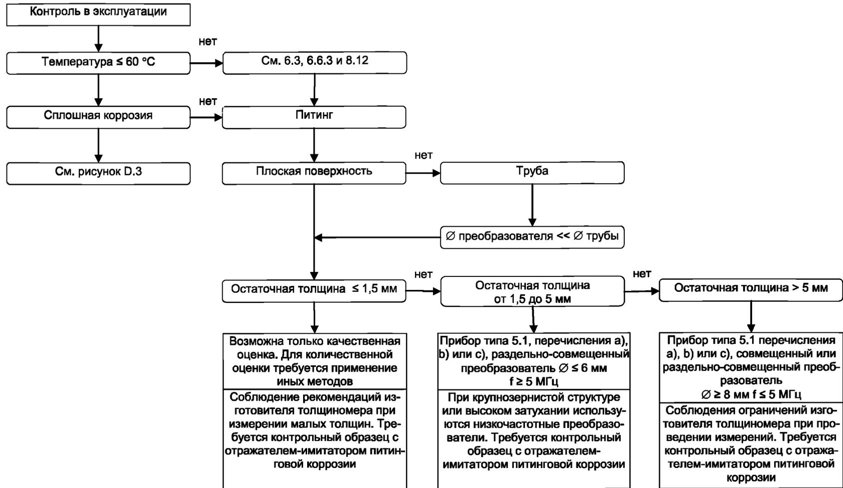
Рисунок D.4 — Блок-схема проведения контроля в эксплуатации
