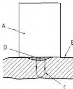
А — преобразователь; В — объект контроля; С — путь ультразвука; D — контактная среда
