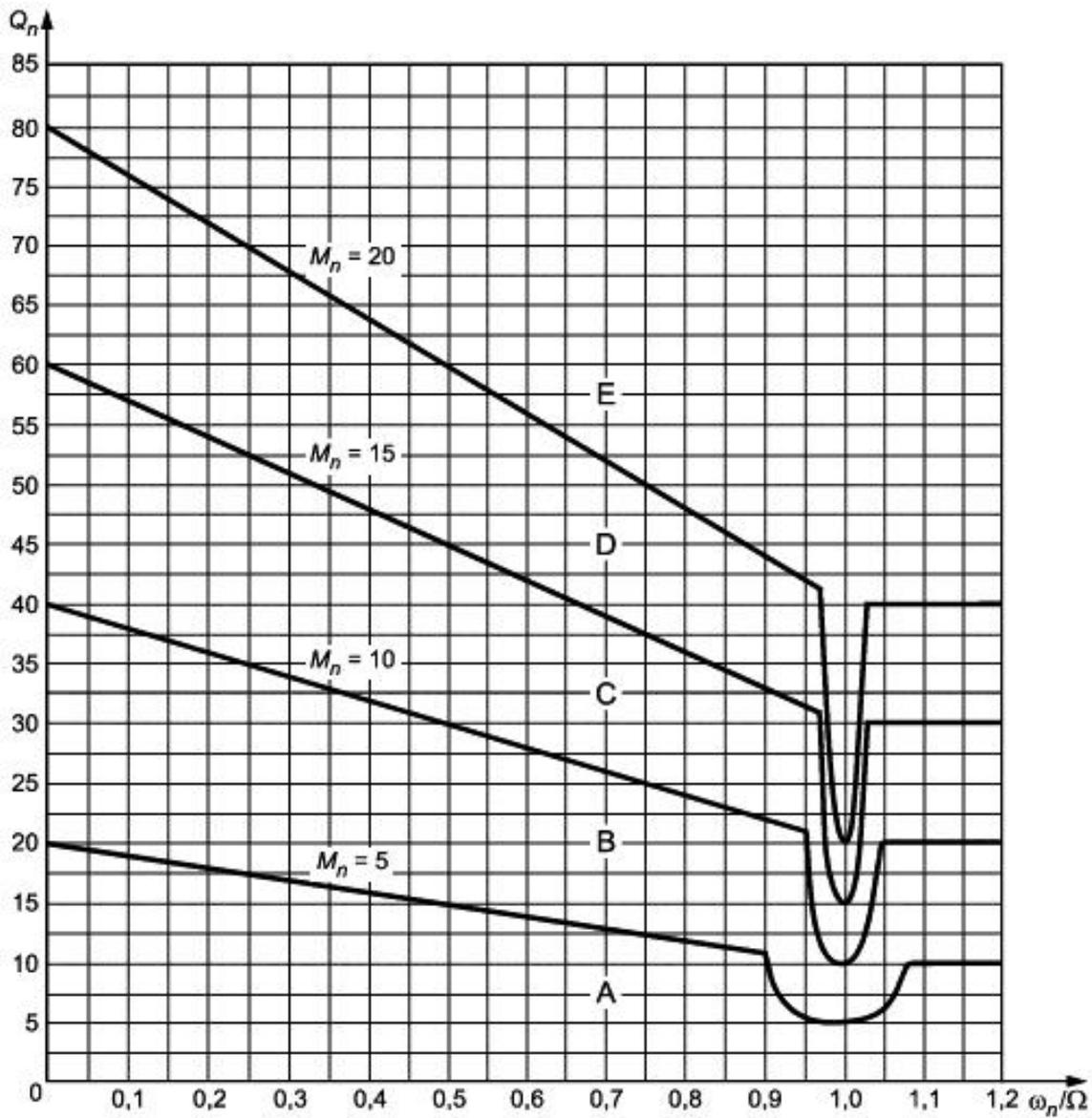
Рисунок 5 - Допустимый коэффициент усиления на резонансе во всем диапазоне частот вращения ротора  $\Omega$
