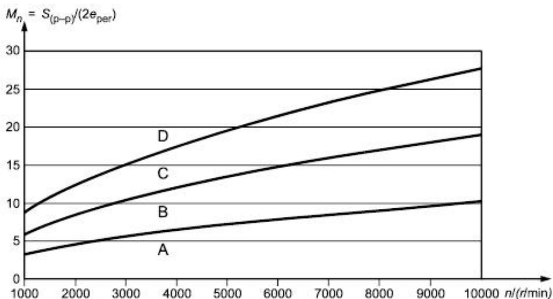
Рисунок 3 - Границы зон вибрационного состояния согласно [2] и [3]
