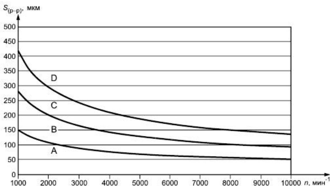
Рисунок 2 - Границы зон вибрационного состояния согласно [2] и [3]
